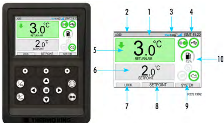
Rysunek 11. Ilustracja ekranu wskazania standardowego i opisów ikon
