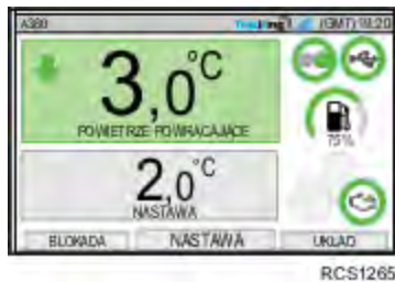
Rysunek 34. Ilustracja przedstawiająca ekran trybu zachowania świeżości
