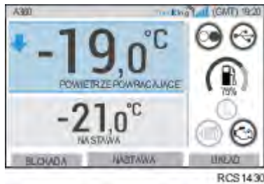
Rysunek 33. Ilustracja przedstawiająca ekran trybu mrożenia
