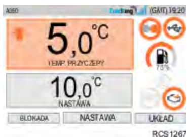
Rysunek 35. Ilustracja przedstawiająca ekran trybu ogrzewania
