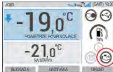
Rysunek 28. Ilustracja przedstawia ikonę silnika elektrycznego zastąpioną ikoną silnika wysokoprężnego
