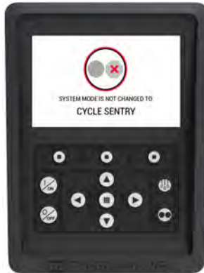
Rysunek 23. Ekran operacji zakończonej niepowodzeniem
