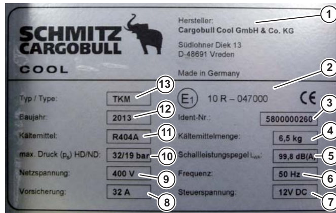
Ilustracja 1: Tabliczka znamionowa Samochodowego agregatu chłodniczego
